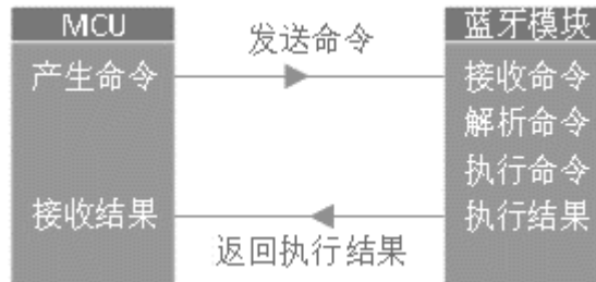
图 4-1 MCU 操作蓝牙模组流程图
